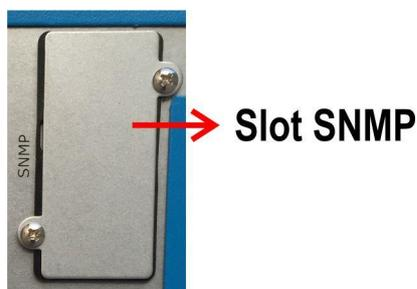
Fig. 16 – Coperchio di protezione slot SNMP.
