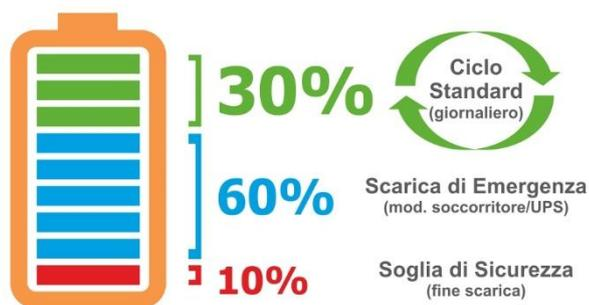
Fig. 20 – La gestione dell’accumulo di enSolar Green.
